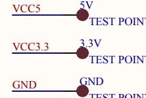
这三个电源电压测试点。可用来测试核心板的电源是否正常。也可以用来给核心板供电：焊接GND和5V，然后接外部5V电压即可。
