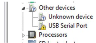
عدم نصب کامل مبدل
