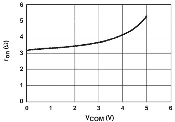
Figure 4.  $r_{on}$  ( $\Omega$ ) vs  $V_{com}$  (V)
