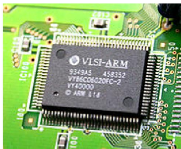
VLSI VY86C06020FC-2 ARM 60 CPU chip
