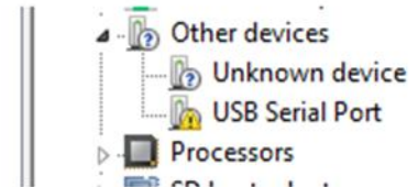
عدم نصب کامل مبدل
