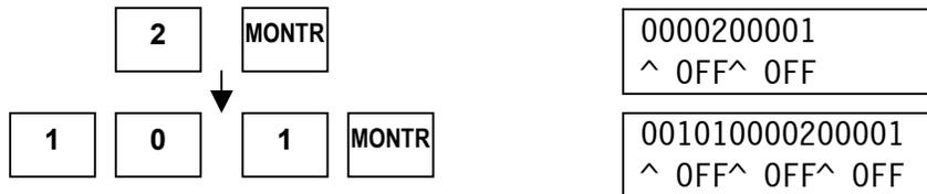
**Ejercicio:** Intercambie a ON y OFF la posición de los conmutadores 01 y 02 montados en el módulo de entrada canal 0 y observe la pantalla.
