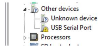
عدم نصب کامل مبدل
