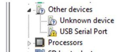
عدم نصب کامل مبدل
