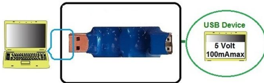
اتصال دستگاه جانبی با ولتاژ کاری 5 ولت و حداکثر جریان کشی 100 میلی آمپر
